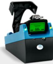
Die GfG-Teststationen bieten schnelle, automatische und kostengünstige Durchführung der arbeitstäglichen Anzeigetests einschließlich der Dokumentation gemäß DGUV-Informationen 213-056 (T021) und 213-057 (T023). Zusätzlich hierzu ermöglichen die Dockingstationen auch die vorgeschriebenen, regelmäßigen Funktionskontrollen.
