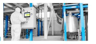
Controller sind gleichermaßen Schaltzentrale und Datendrehscheibe jeder Gaswarnlösung. Sie machen aus den Daten von Transmittern Aktionen. Das können Alarme sein, die Steuerung von Lüftern oder die Weitergabe der Informationen an die Rettungswarte oder Leitstelle.
